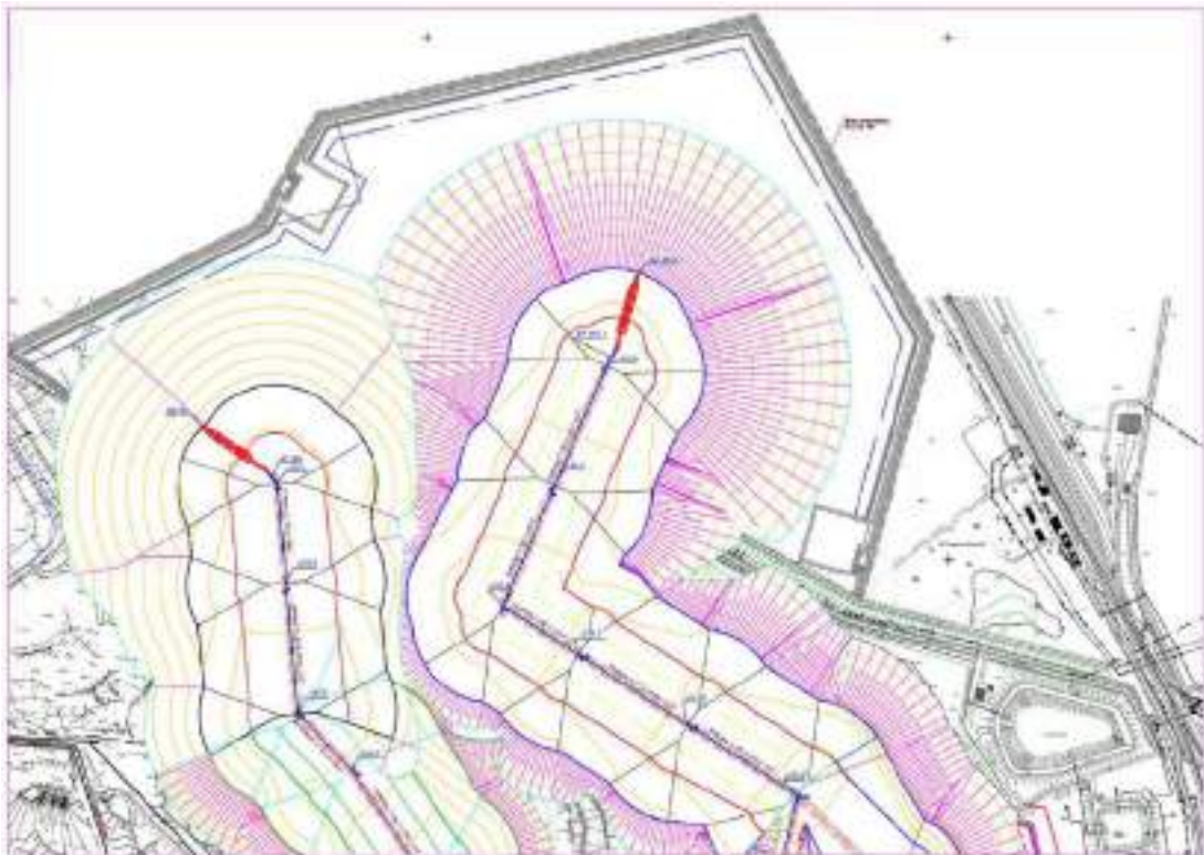
Рисунок 1.6 – План участка солеотвала на конец проектных работ. Третья очередь
