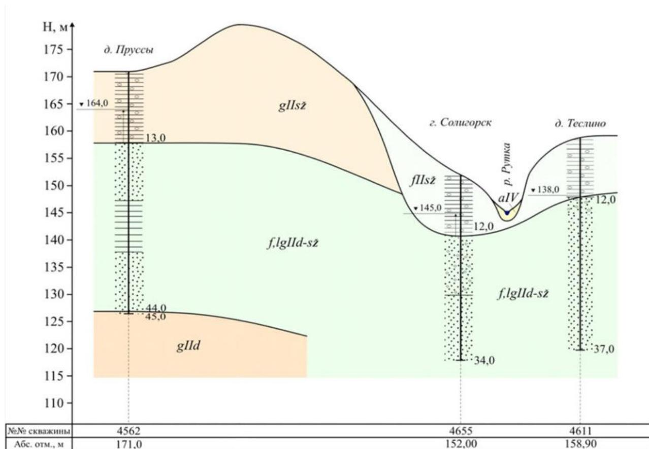
Рисунок 3.7 – Геолого-гидрогеологический разрез
